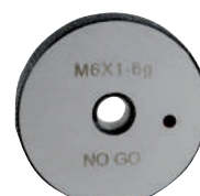
Bague filetée n'entre pas type 195 Tolérance 6g DIN 13 - NF E03-152
