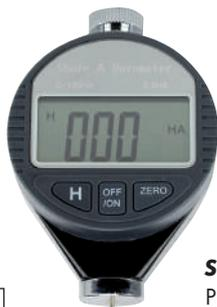
Avec sonde intégrée. Mesure de 0 à 100, résolution 0,5 Shore. Fonction hold pour mettre la plus haute valeur en mémoire. Remise à zéro.
