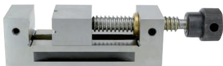
Etau d'outilier en acier trempé, entièrement rectifié. Rainure horizontale en vé et verticale sur mors mobile. Acier stabilisé et rectifié 58-60 HRC.
