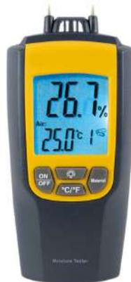
Grand afficheur LCD rétro-éclairé. Lecture du % d'humidité du bois, plâtre, mortier, béton de 0 à 95,7%. 7 matériaux sélectionnables en mémoire. Thermomètre de -10 à +50°C. Commutation °C/°F.
