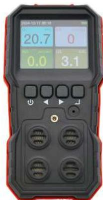
Détecte les gaz : CO monoxyde de carbone, 0-1000 PPM; O2 oxygène, 0-30% vol; H2S hydrogène sulfuré, 0-100 PPM; LEL gaz combustibles, 0-100%.
