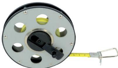
**Ruban acier**, classe II, gradué en mm sur 1 face. Boîtier ajouré alliage d'aluminium inoxydable avec crochet en bout et zéro à la boucle. Manivelle escamotable. Poinçonnage CE.
