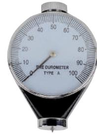
**2. Duromètre SHORE A/D/C**
