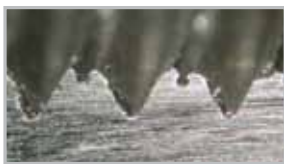
Section de filet obtenu par enlèvement de matière sur de l'acier C45
