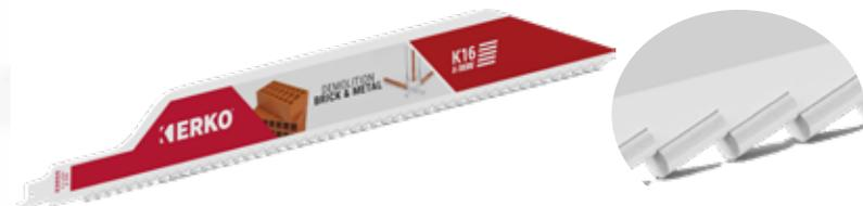
**Denture 5TPI :** pour la **Démolition Brique + Mortier**. Idéale pour créer une ouverture dans un mur en brique très chargé en ciment / mortier colle.
