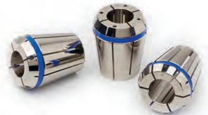
Non seulement les fentes sont ébarbées sur tous les côtés, mais les pinces de serrage disposent aussi d'une profondeur de rugosité moyenne de surface de Rz de 1,6 µm.
