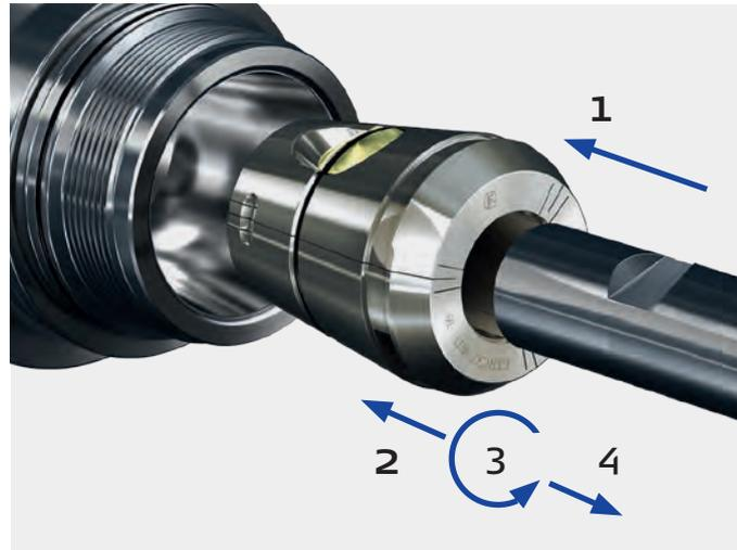
Le ressort de pression de la cale est bloqué dans le logement. Il positionne l'outil automatiquement sur la cale.
