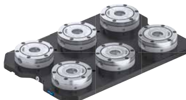
6fach-Spannstation VERO-S NSL plus 600 inkl. 6 Nullpunktspannmodule NSE plus 138
