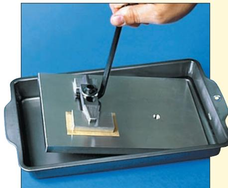
**4** Laisser refroidir la pièce avant de la débrider. Utiliser l'air ou l'eau pour un refroidissement rapide.
