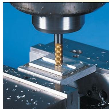
**5** La pièce est prête à usiner. Utiliser un liquide de refroidissement (huile soluble) pour maintenir une température basse. Réchauffer la pièce pour la décoller.
