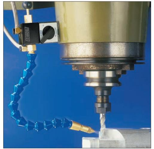
*MINICOOL* utilise le principe Venturi **jet pulvérisé** d'un **mélange air et lubrifiant**.
