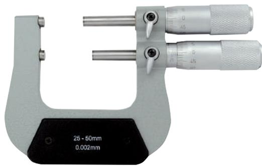
**1. Micromètre entre et n'entre pas**
