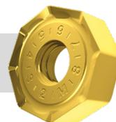
Une nouvelle fraise à surfacer très économique et productive utilisant deux types de plaquettes négatives réversibles. Des plaquettes octogonales ON..06 économiques avec 16 arêtes de coupe pour un APMX de 4 mm, et des plaquettes carrées SN.. 17 productives avec 8 arêtes de coupe pour un APMX de 7 mm. Type à alésage (DC = 50 - 250 mm) disponible avec un pas de denture différentiel. Corps traité pour une plus longue durée de vie de l'outil.
