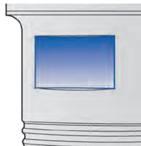
利用刀体上的平衡面进行预平衡
