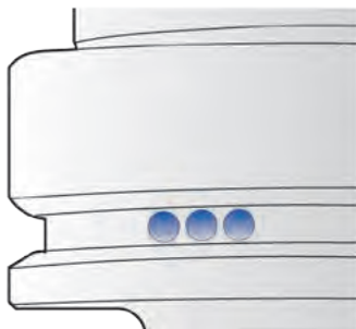
利用法兰平衡孔进行精细平衡
